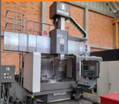
Con capacidad de peso desde 80 hasta 4000 kg y diámetros hasta de 90 centímetros.
