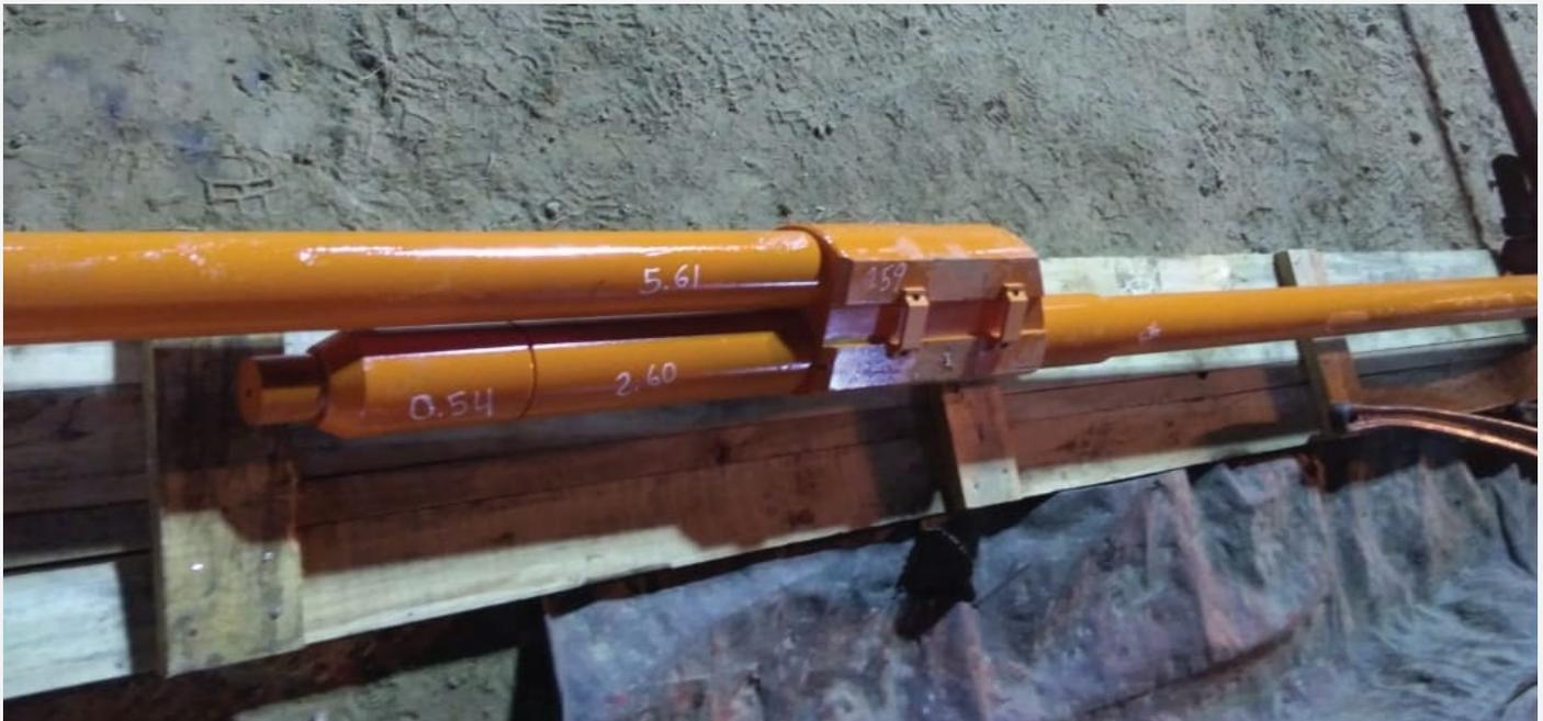
Preparación de ESP Bypass System para instalación
